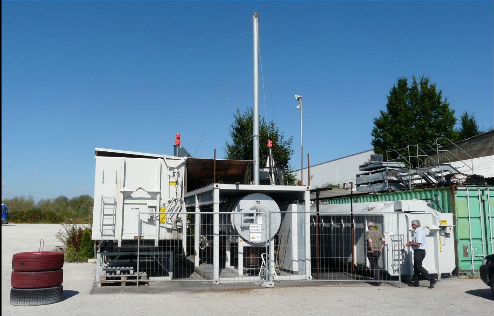
Thermische Karbonisierung (Pyrolyse): Pyreg-System
