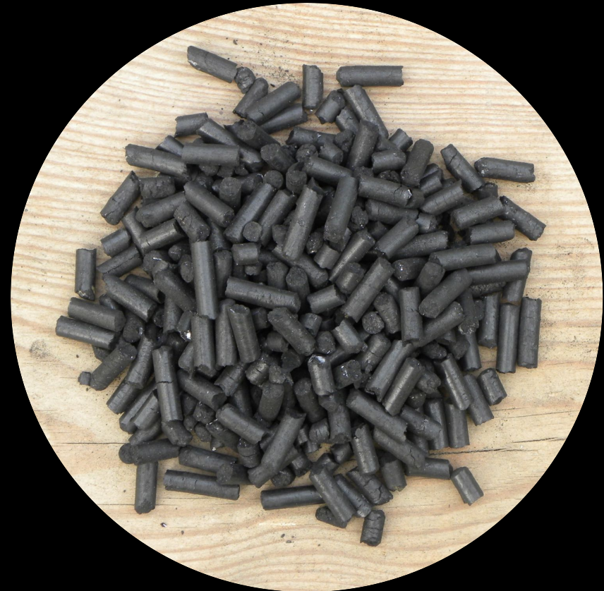
Pellets aus laktatfermentierter Biomasse mit Pflanzenkohle
